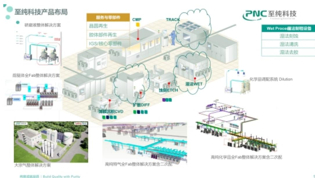
如图，可以看到高纯特气、大宗气系统均和薄膜沉积、干法刻蚀、扩散等工艺机台的腔体连成一个工作面，实现干法工艺目标；高纯化学品、化学品调配系统均和湿法工艺机台的腔体连成一个工作面，实现湿法工艺目标；前驱体系统、EPI 和 ALD 等工艺机台的腔体连成一个工作面，实现其工艺目标；研磨液系统和 CMP 机台连成一个工作面，实现研磨工艺目标。而在制程设备方面，公司重点布局了湿法设备，并在产品平台和工艺搭载了基本覆盖了全部湿法工艺。利用公司对于湿法设备、湿法工艺及配套气化系统的优势，公司布局了晶圆再生和腔体部件再生，以满足核心用户在生产运营周期中的需求。利用公司 20 多年在气体零部件及气路模块的优势，公司布局了支持设备的核心零部件业务，以满足核心终端用户及设备厂商的需求。公司在集成电路领域的布局，立足自身核心技术的优势，为公司长足发展奠定战略基础，力争能够穿越产业不同周期都有平稳营收。
